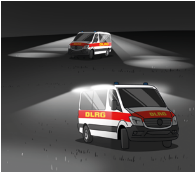
Abbildung: Umfeldbeleuchtung eines Einsatzfahrzeuges
